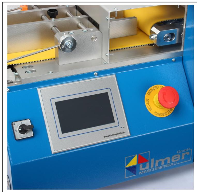
Touchpanel der Schneidemaschine
